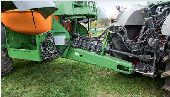
Auf der Deichsel sitzt die Altek-Tridempumpe mit 750 l/min. Das Signal für die Lenkung kommt von einem stabilen Gestänge, das an die „K 50“-Kugel gekoppelt wird. Der separate Rechner dafür sitzt vor dem großen Staufach.
