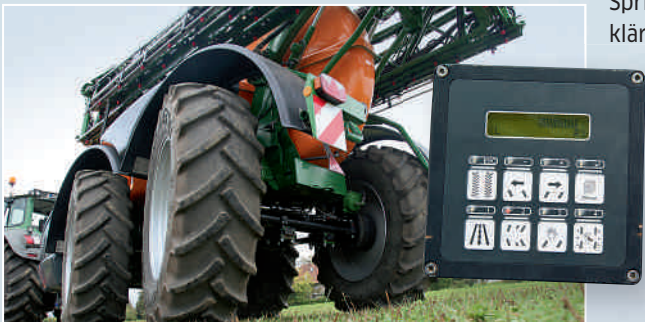
Das hydraulische Fahrwerk hat eine Wankstabilisierung. Die hintere Achse hat 20° Lenkwinkel, während die vordere auf etwa 12° begrenzt ist, damit die Räder nicht radieren. Die Lenkung hat eine eigene Bedieneinheit, wo die verschiedenen Lenkarten eingestellt werden.
