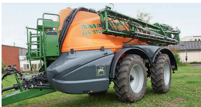
Kompakte Sache: Die Spritze ist nur 2,85 m breit, und die 900 l Frischwasser lagern in zwei Tanks links und rechts zwischen den Rädern.
