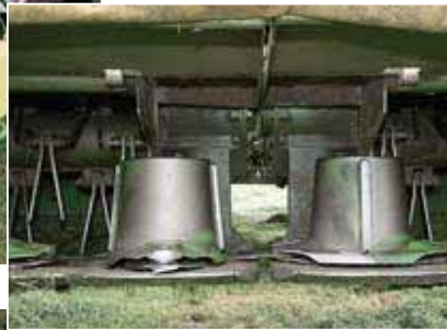
Die Aufbereiterinensität wird über ein Schaltgetriebe und die Riffelblechposition verstellt (links). Die Schnitthöhe wird hydraulisch aus der Kabine angepasst (unten).
