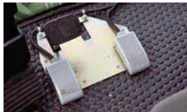
Die Kabine stammt vom Feldhäcksler. Der Fendt-Fahrhebel (kleines Bild oben) gefällt uns immer noch nicht, der Monitor (kleines Bild Mitte) bietet eine gute Übersicht und viele Einstellmöglichkeiten, mit den Pedalen (kleines Bild unten) werden die Hinterräder z.B. hangaufwärts gesteuert.
