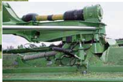
Die Aufbereiterinensität wird über ein Schaltgetriebe und die Riffelblechposition verstellt (links). Die Schnitthöhe wird hydraulisch aus der Kabine angepasst (unten).
