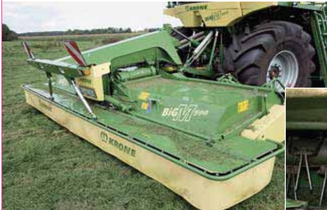
Das 5,30 m breite Frontmäherwerk besteht aus zwei einzelnen Holmen, die direkt nebeneinander arbeiten.
