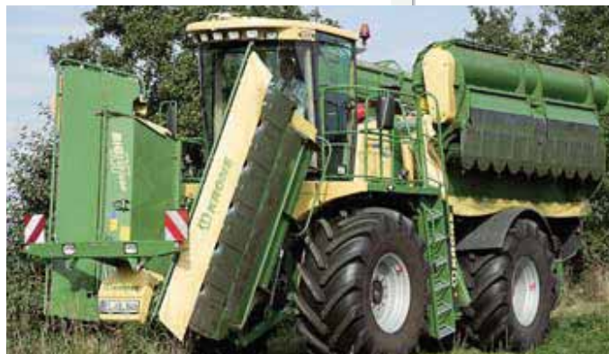
In Transportstellung ist der BiG M 500 mit 800er Reifen 3 m, mit 900er Reifen 3,20 m breit. Die Sicht nach vorne durch und über das V-förmig zusammengeklappte Frontmähwerk geht in Ordnung.
