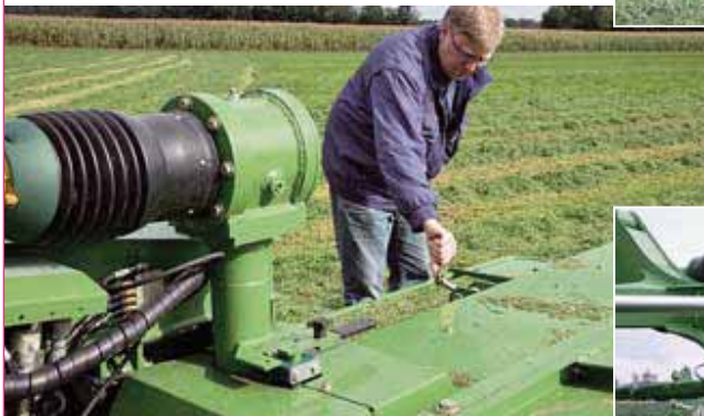
Die Aufbereiterinensität wird über ein Schaltgetriebe und die Riffelblechposition verstellt (links). Die Schnitthöhe wird hydraulisch aus der Kabine angepasst (unten).
