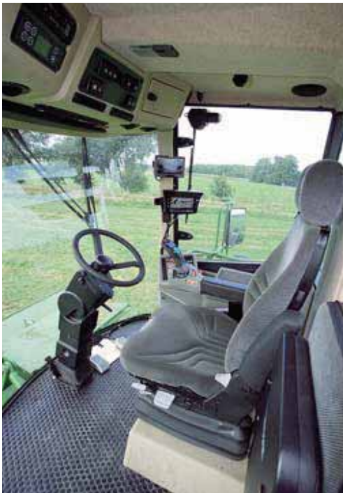
Die Kabine stammt vom Feldhäcksler. Der Fendt-Fahrhebel (kleines Bild oben) gefällt uns immer noch nicht, der Monitor (kleines Bild Mitte) bietet eine gute Übersicht und viele Einstellmöglichkeiten, mit den Pedalen (kleines Bild unten) werden die Hinterräder z.B. hangaufwärts gesteuert.
