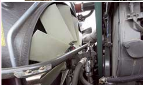
Unter der mächtigen Haube arbeitet der C 13 von Caterpillar. Eine Besonderheit sind der hydraulisch angetriebene Lüfter und die zwei Lichtmaschinen für das 12- und 24-Volt-Bordnetz.
