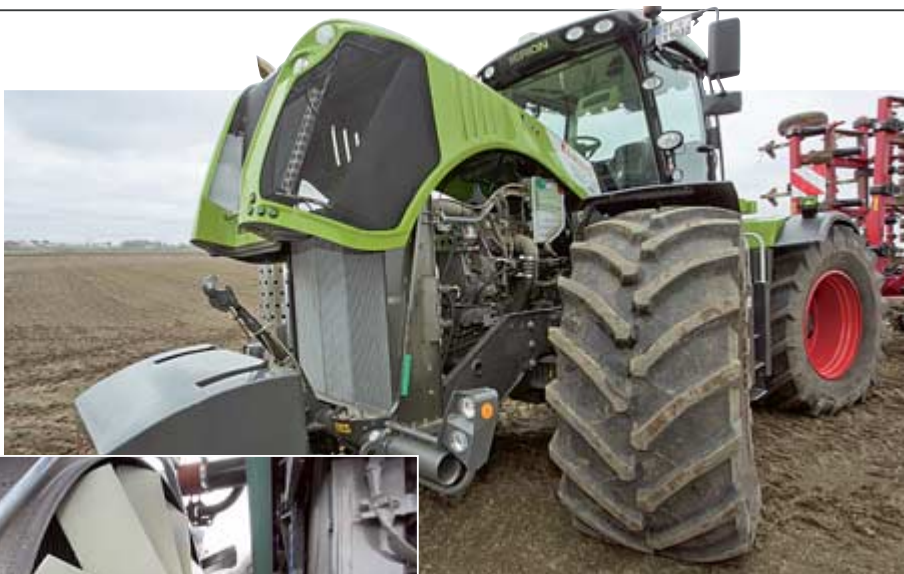
Unter der mächtigen Haube arbeitet der C 13 von Caterpillar. Eine Besonderheit sind der hydraulisch angetriebene Lüfter und die zwei Lichtmaschinen für das 12- und 24-Volt-Bordnetz.
