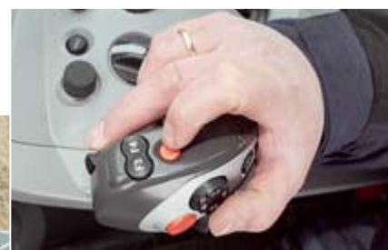
Ganz neu ist das Bedienkonzept: Der Multifunktionsgriff für mehr als 20 Funktionen wird mit drei Fingern bedient. Je nach Fahrer-Erfahrung können im Cebis-Monitor die Untermenüs in drei Ebenen freigeschaltet werden (Anfänger, Profi, Experte).
