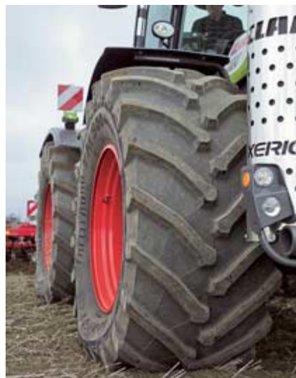
Die 2,16 m hohen Räder der Größe 900/60 R 42 können bei 21 t Gesamtgewicht mit 1 bar gefahren werden. Der Xerion 5000 ist damit 3,29 m breit.
