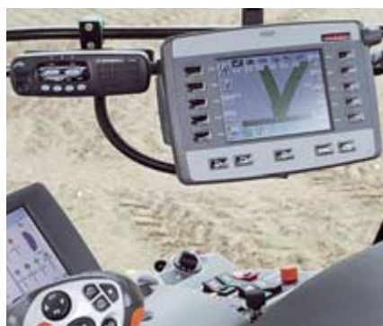
Das „Cebis Mobile“ ist ISO-fähig. Hier wird auch das neue GPS-Lenkssystem (in Zukunft auch mit RTKnet) bedient.
