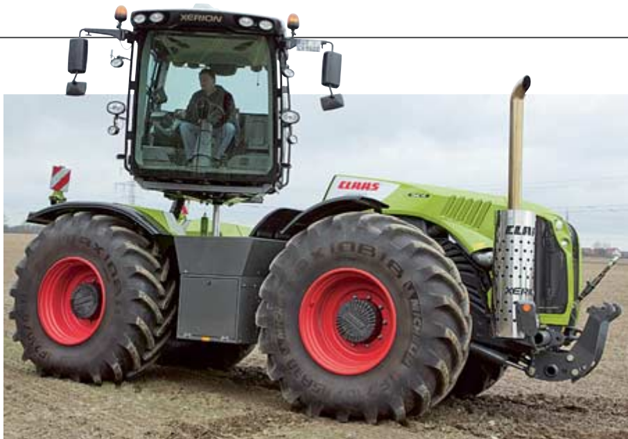
Auch den neuen Xerion gibt es für knapp 18 000 Euro Aufpreis als „Trac VC“ mit drehbarer Kabine – die perfekte Rückfahreinrichtung!
