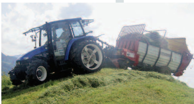
Bodenwelle: Die Knickdeichsel führt die Pickup automatisch über Bodenwellen, ein Sensor misst dazu den Abstand zwischen Pickup und Ladewagenchassis.
