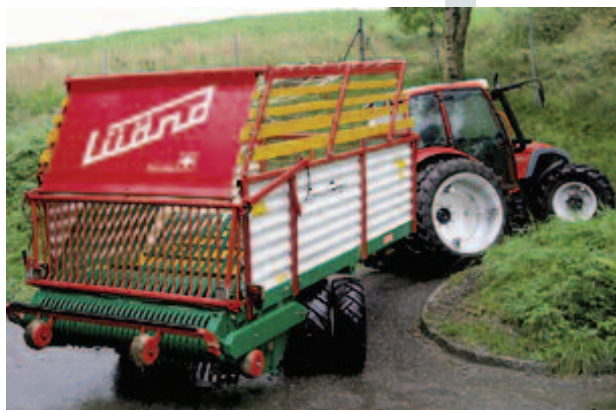
Bodenwelle: Die Knickdeichsel führt die Pickup automatisch über Bodenwellen, ein Sensor misst dazu den Abstand zwischen Pickup und Ladewagenchassis.
