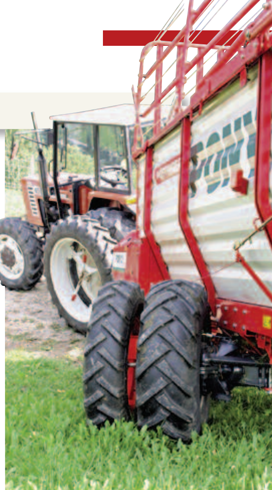
Die gelenkte Triebachse von Urs Schmid Landmaschinen wird mechanisch angetrieben, hydraulisch gelenkt und elektronisch bedient.
