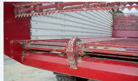
Das Getriebe des Kratzbodenantriebs ist nun mittig angeordnet. Es wird entweder mechanisch oder hydraulisch mit Kraft versorgt. Auf Wunsch gibt es zwei Dosierwalzen.
