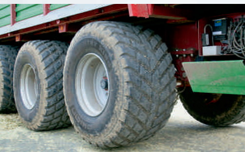
Die erste Achse des hydraulisch-pneumatisch gefederten Fahrwerks kann zur Straßenfahrt angehoben werden.
