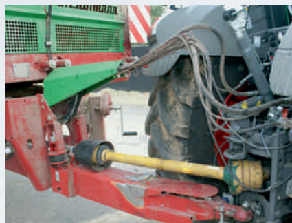
Die Anhängelung der schmalen gummi gedämpften Deichsel erfolgt unten, der Signalgeber der elektrohydraulischen Lenkung sitzt geschützt unter einem Blech.
